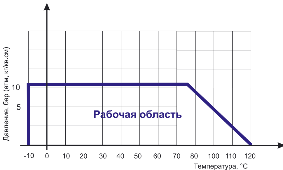
Диаграмма Давление / Температура для задвижки клиновой ABRA-A40-10G с обрезиненным клином и невыдвижным штоком Ду200-600 Ру10:
