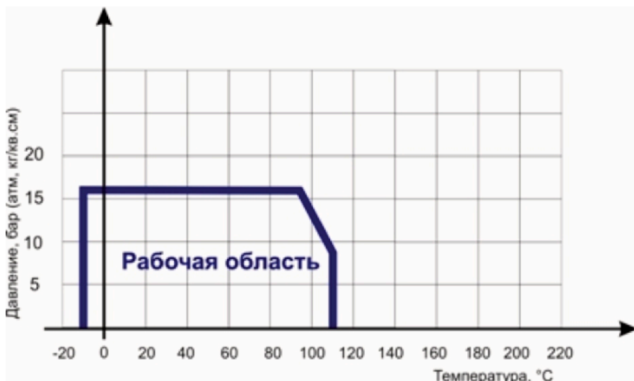
Диаграмма Давление / Температура для затвора поворотного дискового ABRA-BUV-VF826Dxxx Ду40-300, Ру 16
