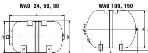
2.2. Расширительные баки рассчитаны на рабочую температуру до +100 °C, замерзание воды в баке не допускается.
