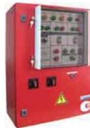
цессе работы давление в системе восстанавливается, с задержкой времени происходит останов основного насоса, при дальнейшем падении давления с задержкой времени происходит повторный пуск насоса. То есть шкаф управления пожарными насосами начинает работать как система повышения давления с заданными временными задержками. Останов режима пожаротушения осуществляется переводом переключателя в положение Стоп на передней панели.
