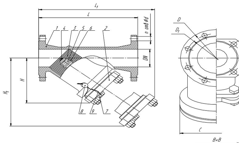
1-корпус; 2-крышка; 3-сетка;4-стержень; 5-магниты ; 6-шайба; 7-пробка для ФМФ;
